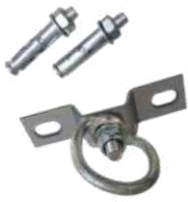
AVESSA SA 20 BOKS TORBASİ TAVAN ASKI APARATI DÖNER MEKANİZMALI Ebatlar 12 cm x 2,5 cm Plaka sac kalınlığı 3 mm Aski halkası et kalınlığı 7 mm çelik Halka dahil yükseklik 7 cm 2 adet çelik dübel dahildir.
