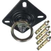
AVESSA PA 44 BOKS TORBASİ TAVAN ASKI APARATI DÖNER MEKANİZMALI Ebatlar 10 cm x 8,5 cm Plaka sac kalınlığı 3 mm Aski halkası et kalınlığı 7 mm çelik Halka dahil yükseklik 8 cm 4 adet çelik dübel dahildir.
